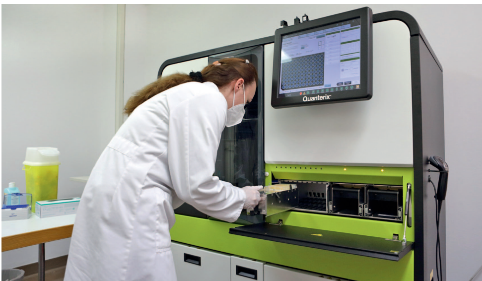
Abb. 5: SIMOA-Analysegerät zur Bestimmung der NfL-Konzentration, ermöglicht durch die Boris Canessa ALS Stiftung: Bedienung des Gerätes durch eine wissenschaftliche Projektmitarbeiterin. Für die Bestimmung der NfL-Konzentration wird die Single Molecule Analysis-Methode (SIMOA) eingesetzt.
